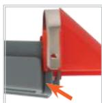
5. Allineare la nuova lama dello sbucciatore con i rilievi del supporto della lama, quindi far scorrere la lama sul supporto finché non scatta saldamente in posizione. Accertarsi che la lama sia fissata saldamente al portalama prima di procedere.
